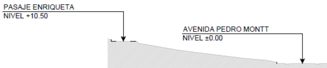
Corte transversal de Avda. Pedro Montt a la altura de calle Alberto Barros
